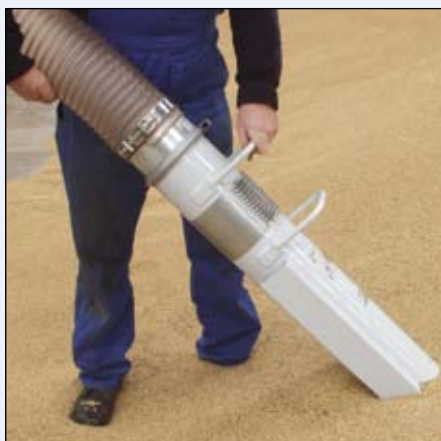
Kulatá sací hlava – pro nasávání z jednoho místa, například otvorem ve stěně sila, je vhodná i pro nasávání z hromad. Vysoká přepravní výkonnost.
