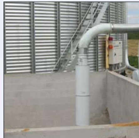
Dlouhá sací hlava – k sání z hlubokých jam a příjmových košů. Vysoká výkonnost. Lze pomocí prodlužovací sekce prodloužit o 0,65 m.
