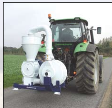
Nasávací pneumatické dopravníky řady SUC-T jsou nesené v třibodovém závěsu traktoru a poháněné jeho vývodovým hřídelem. V nabídce jsou dva modely.
