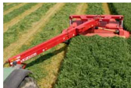
Stroje Flex mají dlouhou, robustní tažnou tyč uchycenou uprostřed stroje. Na obrázku je stroj GMT 3605 Flex P.
