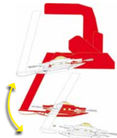
Contour Float Žací lišta se naklápí dopředu a dozadu (16°) tak, aby byla neustále rovnoběžná s povrchem terénu.
