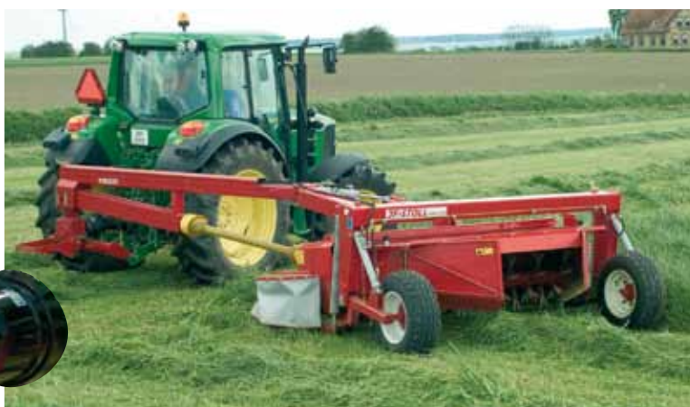
Všechny stroje GMS a GMT (na obr. GMS 280) jsou osazeny úhlovými převodovkami na tažné tyči. Manévrování se strojem je díky tomu velmi snadné, a to i při vysokých rychlostech.
