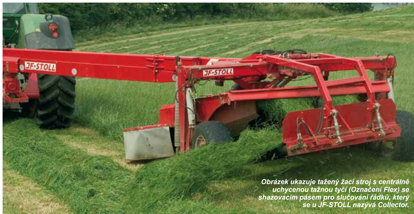
Stroje Flex mají dlouhou, robustní tažnou tyč uchycenou uprostřed stroje. Na obrázku je stroj GMT 3605 Flex P.
