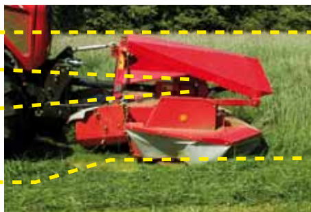
Contour Float – volnost pohybu ve svislém směru až 55 cm
