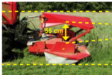
Contour Float – volnost pohybu ve svislém směru až 55 cm
