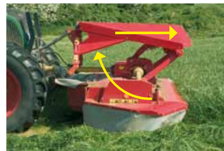
Contour Float – lišta je vlečená v nahoře umístěném hlavním rámu
